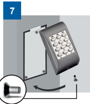
1 (M3 x 6mm) Schwenken Sie die Tastatur von oben ein und befestigen Sie das Gerät mit der beiliegenden Spezialschraube.
