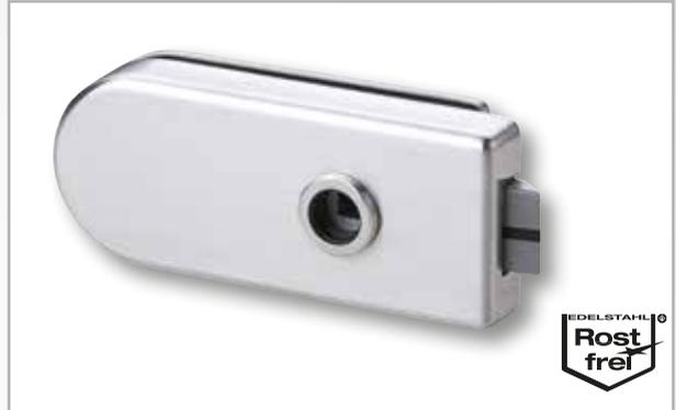
Unverschließbar, Rundform für Ganzglastüren, Glasstärke 8/10 mm Falztiefe 24 mm bei 8 mm Glasstärke mit geräuscharmer Schlossfalle und Klemmnuß ohne Drücker
