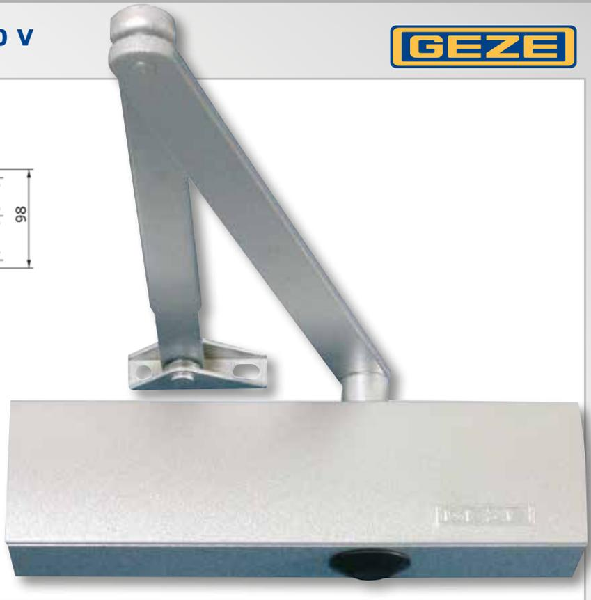
Beim Oberliegenden Türschließer TS 2000 V mit variabler Schließkraft gemäß DIN EN 1154 in Größe 2, 4 und 5 ist die Schließgeschwindigkeit bequem von vorn einstellbar. Die Endschlageinstellung erfolgt über das Gestänge. max. Türflügelbreite 1250 mm
