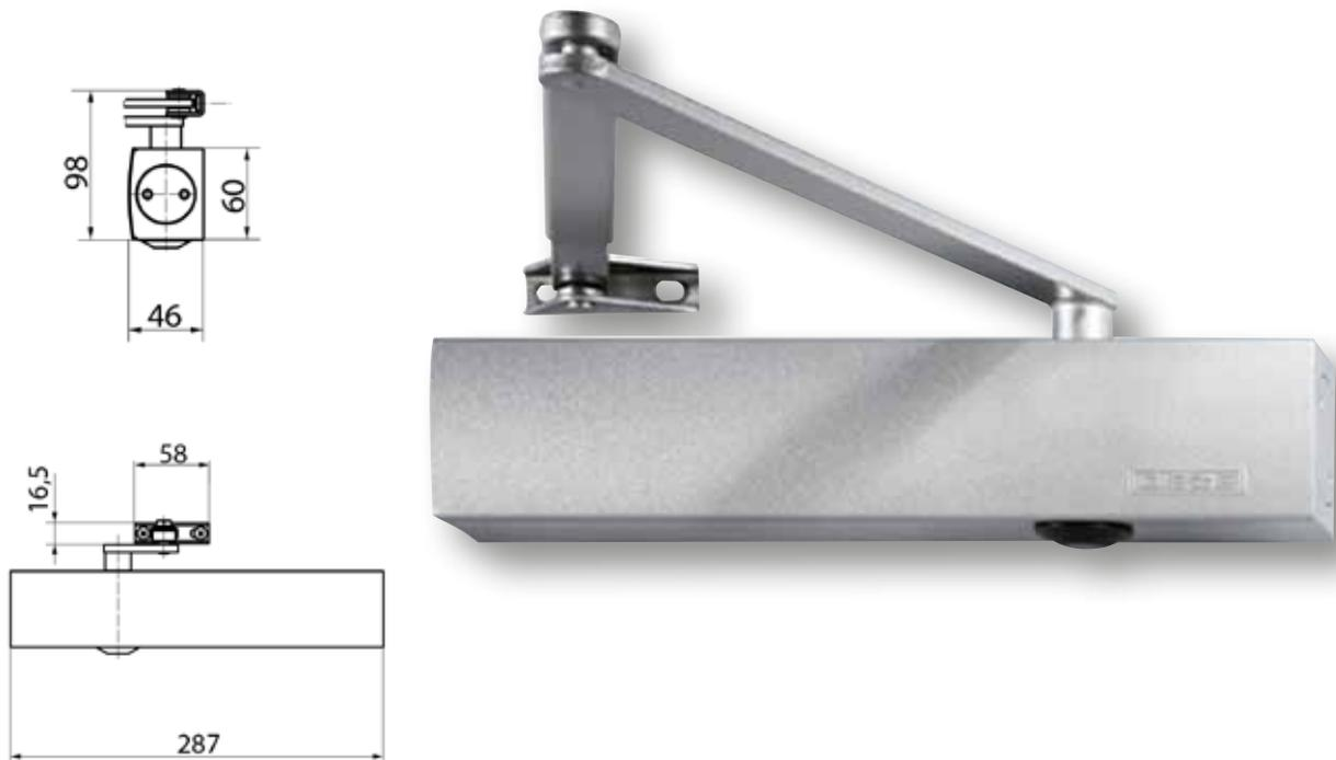
Beim Oberliegenden Türschließer TS 4000 ist die Schließkraft stufenlos von vorn einstellbar und durch eine optische Größenanzeige leicht kontrollierbar. Die Öffnungsdämpfung sowie die thermostabilisierte Schließgeschwindigkeit sind ebenfalls von vorn regulierbar max. Türflügelbreite 1400 mm
