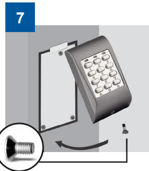
1 (M3 x 8mm) Schwenken Sie die Tastatur von oben ein und befestigen Sie das Gerät mit der beiliegenden Spezialschraube.
