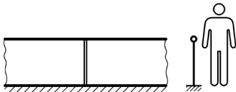
Bild 10 Beispiel einer Kategorie B Verglasung nach DIN 18008-4 Abs.1
