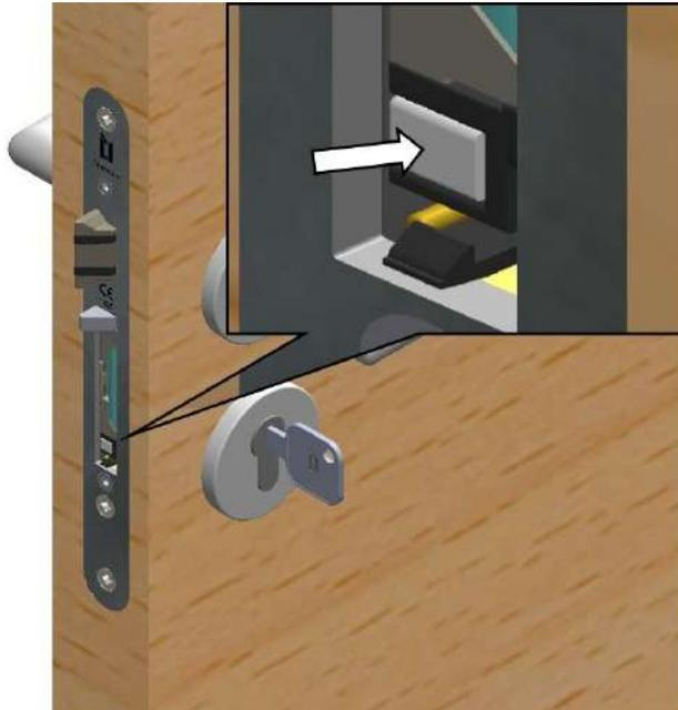
Zum Anlernen den Anlernknopf am Schloss kurz betätigen (LED blinkt grün), anschließend den oberen Knopf der Funkfernbedienung drücken ☺ (LED flackert grün).
