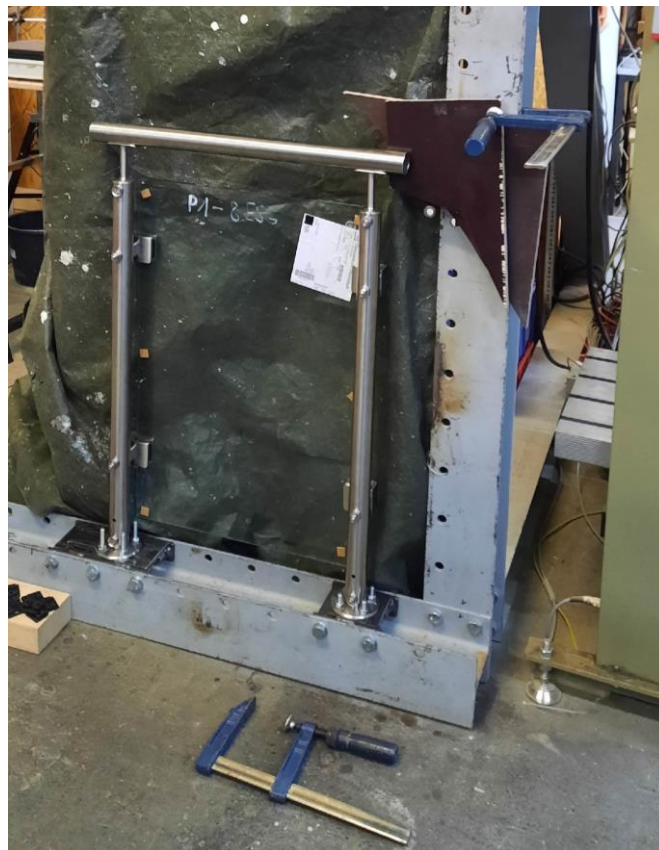
Abbildung 8: Prüfkörper PK 22-02-01 – teilweise ausgesteift
