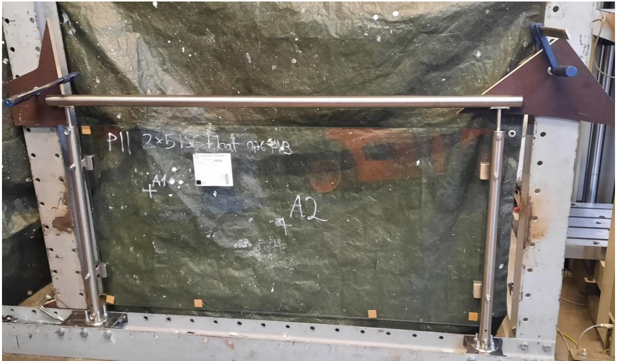
Abbildung 7: Versuchsaufbau für eine breite Scheibe mit ausgesteiften Pfosten
