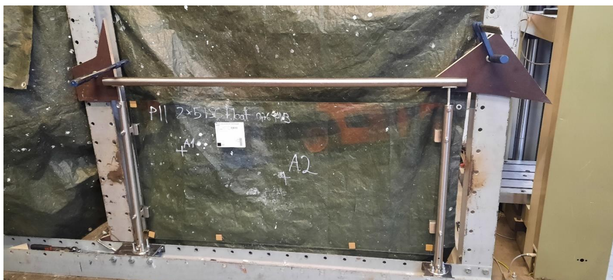
Abbildung 9: Prüfkörper PK 22-02-01 – beidseitig ausgesteift
