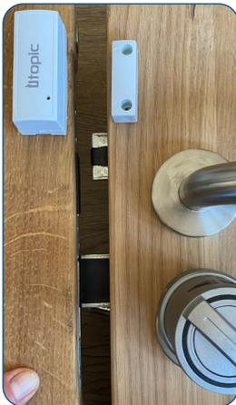
Entfernen Sie den Magneten für 3 Sekunden vom Modul
