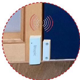
Das Modul sendet, sobald die Tür geschlossen ist und sich Modul und Magnet gegenüberstehen, ein Funksignal an das ÜTopic mit dem Befehl die Tür zu verriegeln.
