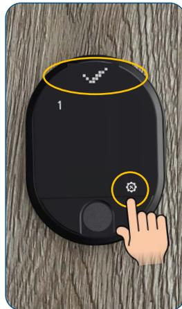
Berühren Sie die rechte Menü-Taste bzw. Einstellungstaste bis im Display das OK-Zeichen (Häkchen) erscheint. Das Gerät wurde erfolgreich zurückgesetzt. Im Anschluss schaltet sich der Fingerabdruckleser mit integrierter Tastatur aus
