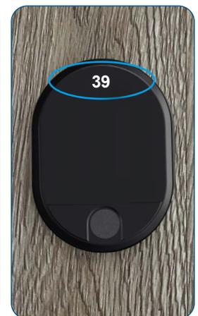
Alle Tastenfelder erlischen. Im Display erscheint die Anzahl der eingespeicherten Fingerabdrücke,... z.B. 39. Im Anschluss schaltet sich das Gerät aus
