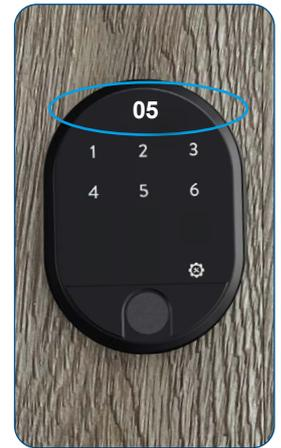
Im Display erscheint die Anzahl der vergebenen Passwörter,... z.B. 05. Im Anschluss schaltet sich das Gerät ab
