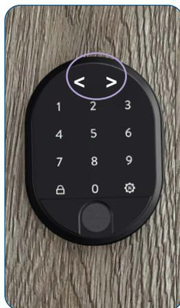
Die LED Anzeige wird aktiviert und im Display erscheinen zwei in entgegengesetzte Richtungen weisende Pfeile < >
