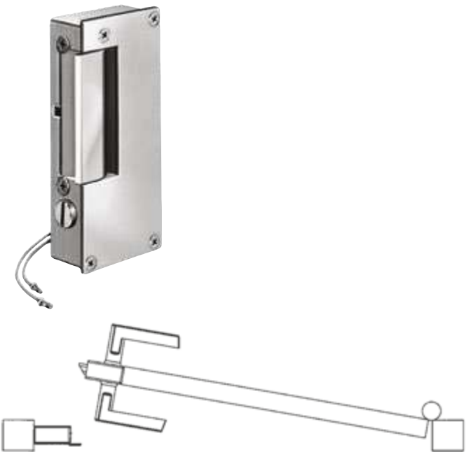
Beispiel: Türanschlag DIN links mit elektrischem Türöffner DIN rechts
