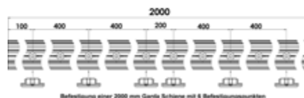
Befestigung einer 2000 mm Glas-Schiene mit 6 Befestigungspunkten
