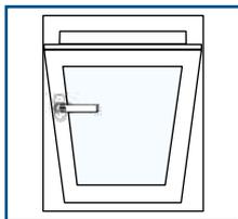
Obwohl der Griff verriegelt ist, lässt er sich um 90° drehen. Bei Verwendung eines TBT-Beschlages kann das Fenster in dieser Position nur noch gekippt werden.
