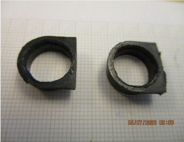
Lagerbuchsen im Vergleich (unverbaut / verbaut) nach 100.000 Zyklen (öffnen / schließen).
