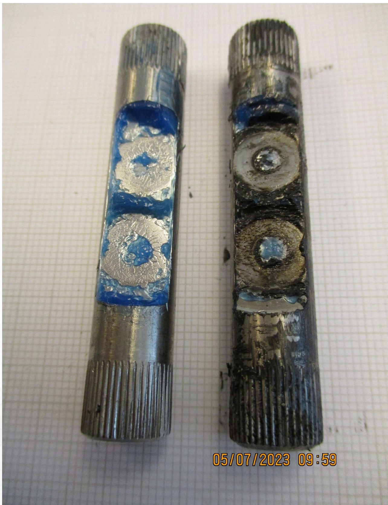
Achsen im Vergleich (unverbaut / verbaut) nach 100.000 Zyklen (öffnen / schließen).
