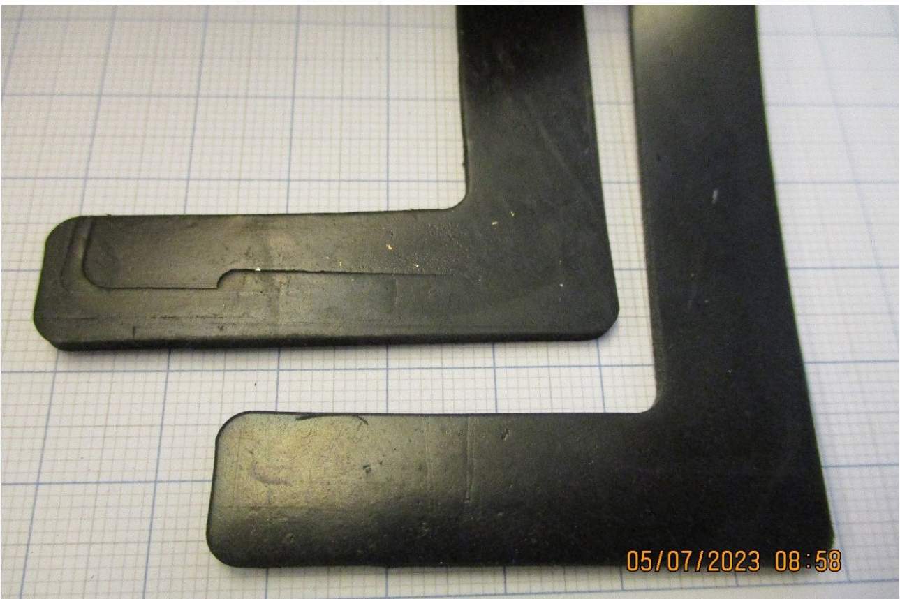
Zwischenlagen im Vergleich (verbaut / unverbaut).
