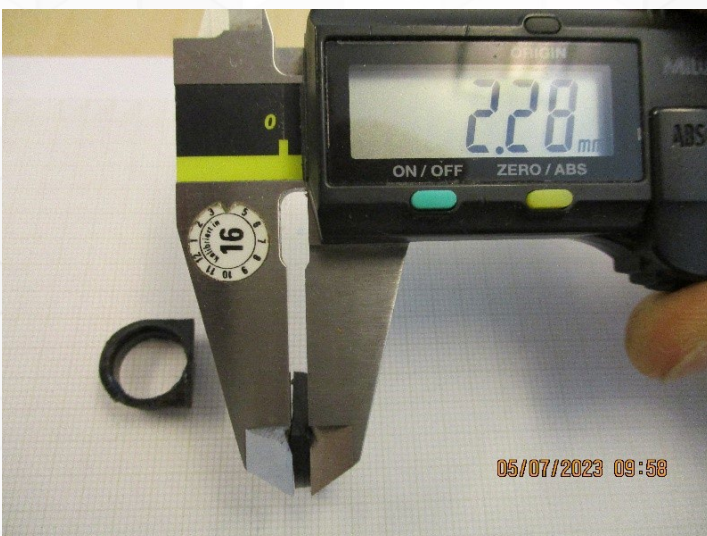
Lagerbuchse verbaut. Keine auffälligen Veränderungen in Maß und Form nach 100.000 Zyklen (öffnen / schließen) festzustellen.
