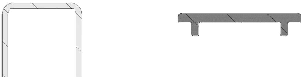
**Bild 4** U-Profil aus Edelstahl links und Aluminium EN AW 6063 T66 rechts
