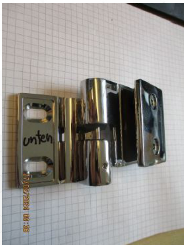
Verschleißerscheinungen nach dem Test / 50.000 Zyklen (öffnen / schließen)
