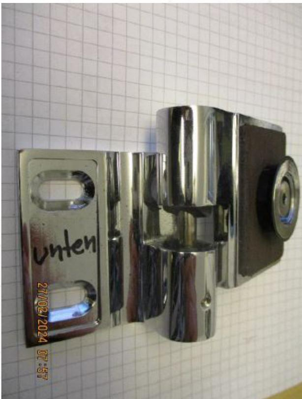
Verschleißerscheinungen nach dem Test / 50.000 Zyklen (öffnen / schließen)
