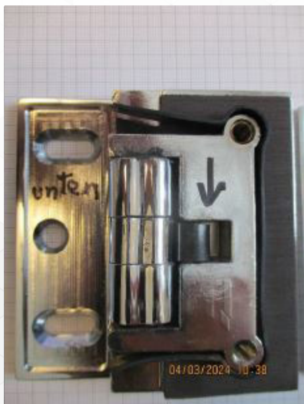
Verschleißerscheinungen nach dem Test / 50.000 Zyklen (öffnen / schließen)
