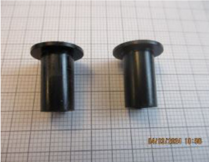
Lagerbuchsen im Vergleich (verbaut/unverbaut) nach 50.000 Zyklen (öffnen / schließen)
