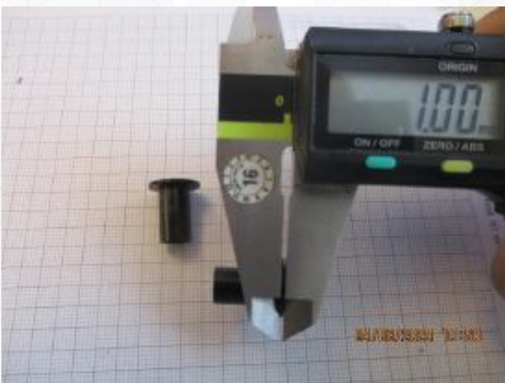
Lagerbuchse verbaut. Keine auffälligen Veränderungen in Maß und Form nach 50.000 Zyklen (öffnen / schließen) festzustellen.
