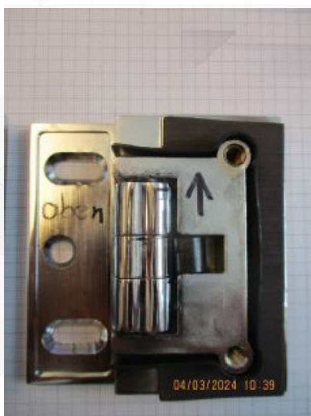
Verschleißerscheinungen nach dem Test / 50.000 Zyklen (öffnen / schließen)
