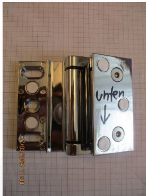
Verschleißerscheinungen nach dem Test / 50.000 Zyklen (öffnen / schließen)
