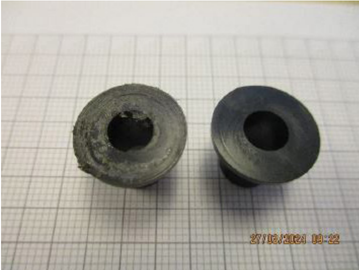
Lagerbuchsen im Vergleich (verbaut/unverbaut) nach 50.000 Zyklen (öffnen / schließen)
