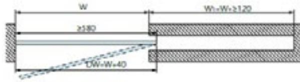
Innen-Schiebetürbeschlag für Glastüren 8/10 mm, Laufschiene Aluminium F1, geeignet für in der Wand laufend, Deckenmontage.
