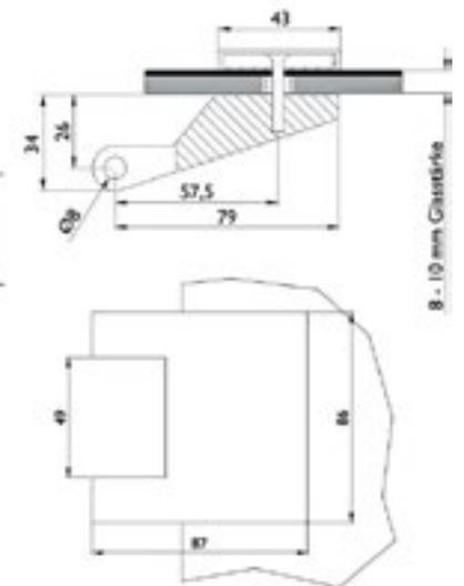
(\*10) mm – Die Glasürsets sind passend für Zargen mit 24 mm Falztiefe bei 8 mm Glasdicke. Beim Einsatz mit 10 mm ESG-Glas muss entweder eine Zarge mit 26 mm Falztiefe verwendet werden oder eine Austauschfalle - siehe Zubehör - dazu bestellt werden
