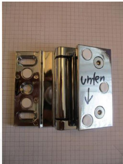
Verschleißerscheinungen nach dem Test / 100.000 Zyklen (öffnen / schließen)
