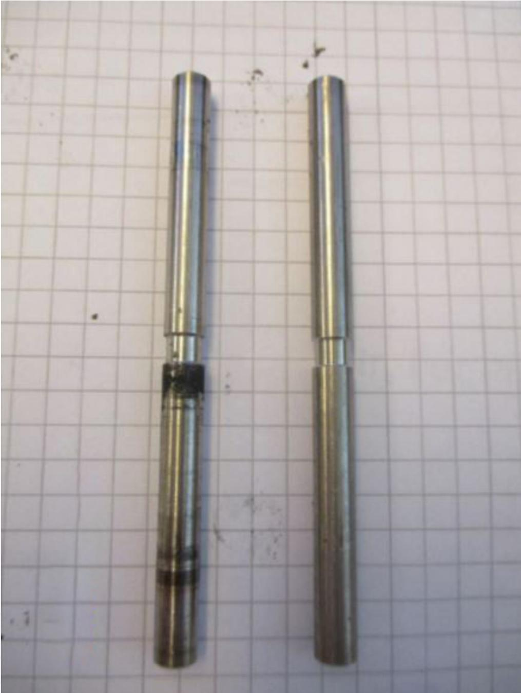
Achsen im Vergleich (verbaut/unverbaut) nach 100.000 Zyklen (öffnen / schließen).
