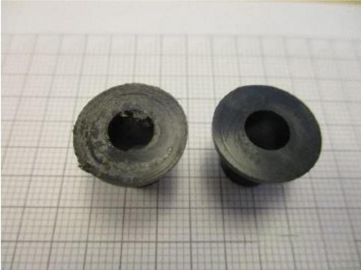
Lagerbuchsen im Vergleich (verbaut/unverbaut) nach 100.000 Zyklen (öffnen / schließen)
