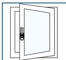
Um den Griff in die 180°-Position zu bewegen, ist es erforderlich, den Zylinder mithilfe eines Schlüssels zu entsperren. Erst nach dieser Entriegelung kann das Fenster vollständig geöffnet werden.
