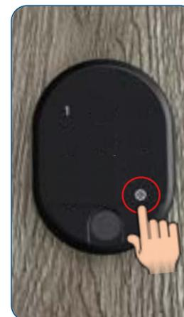
Bestätigen Sie die gewünschte Funktion mit der rechten Menütaste bzw. Einstellungstaste. Falls Sie das Gerät auf OFF gesetzt haben, funktioniert das Masterpasswort künftig nicht mehr, sondern nur noch der Masterfingerabdruck! Sie können die Funktion aber jederzeit wieder aktivieren.
