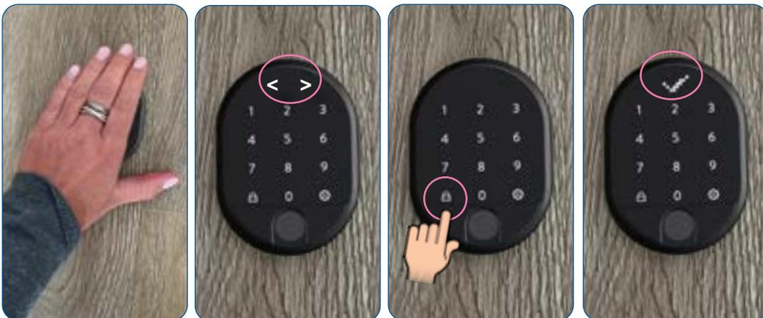
Wecken Sie das Gerät auf, indem Sie die Handfläche auf die Oberfläche des Fingerprintlesers mit integrierter Tastatur legen.
