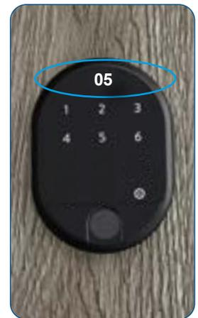
Am Display erscheint die Anzahl der vergebenen Passwörter,... z.B. 05. Im Anschluss schaltet sich das Gerät ab.
