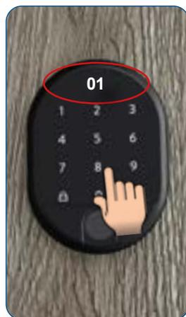
.... gleich darauf scheint am Display die Zahl 01 auf. Das Masterpasswort wurde erfolgreich an Position 01 abgeändert. Das Gerät schaltet sich automatisch aus.
