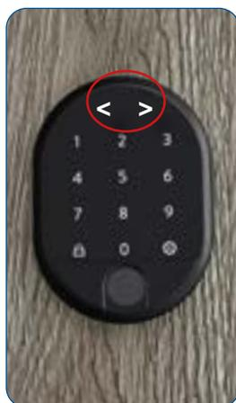
Die LED Anzeige wird aktiviert und am Display erscheinen zwei in entgegengesetzte Richtungen weisende Pfeile < >.
