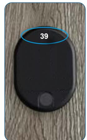
Alle Tastenfelder erlischen. Am Display erscheint die Anzahl der eingespeicherten Fingerabdrücke,... z.B. 39. Im Anschluss schaltet sich das Gerät aus.
