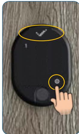
Berühren Sie die rechte Menütaste bzw. Einstellungstaste, bis am Display das OK-Zeichen (Häkchen) erscheint. Das Gerät wurde erfolgreich zurückgesetzt. Im Anschluss schaltet sich der Fingerabdruckleser mit integrierter Tastatur aus.
