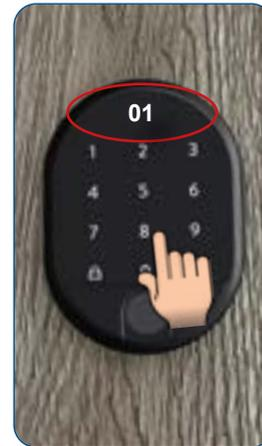
.... gleich darauf scheint am Display die Zahl 01 auf. Das Masterpasswort wurde erfolgreich an Position 01 hinterlegt. Das Gerät schaltet sich aus.
