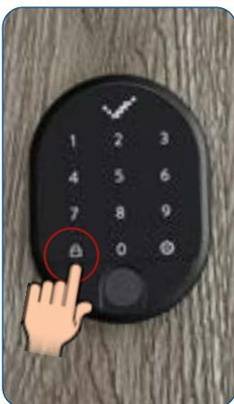
Berühren Sie die untere linke Taste bzw. Sperrtaste und die Tür wird verriegelt.
