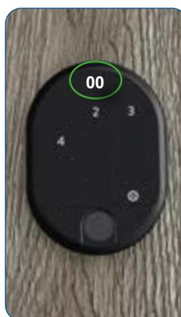
Am Display erscheint 00 und es leuchten nur jene Tastenfelder auf, welche mit einem Passwort hinterlegt sind (in diesem Fall 02-04). Die 01 ist als Masterpasswort vergeben und kann nicht gelöscht werden. Deshalb ist die 1 nicht beleuchtet.
