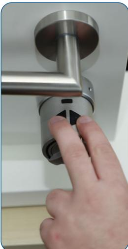
Bereiten Sie das Ladekabel vor, indem Sie es in die Steckdose einstecken. Halten Sie beide Tasten so lange gedrückt, bis der zweite lange Piepton zu hören ist. Lassen Sie die Tasten aus und stecken zügig das Ladekabel an. Nach dem Einstecken erklingt nochmals ein kurzer Piepton.
