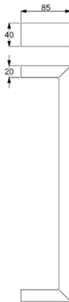
Stoßgriff ohne Befestigungsmaterial und Montagezubehör, Stütze gerade
