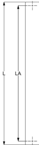
Stoßgriff ohne Befestigungsmaterial und Montagezubehör, Stütze gerade
